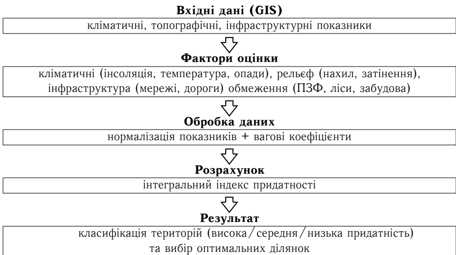
Рис. 1. Схема оцінки придатності земель для розміщення сонячних електростанцій на основі багатокритеріального аналізу [4]
