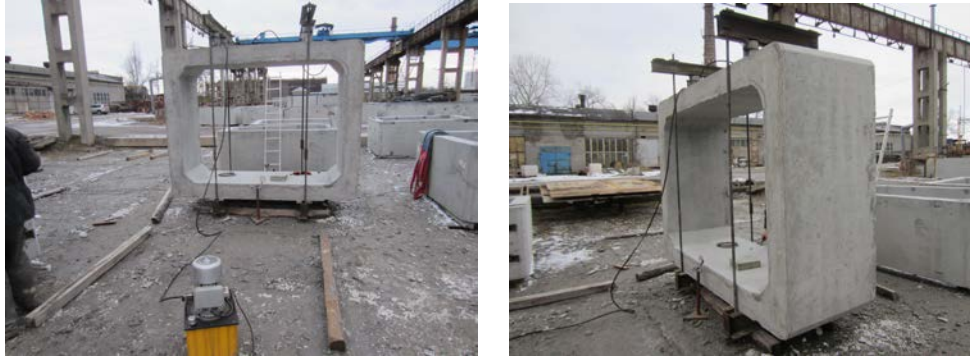
Рис. 2. Схема навантаження на блок модульної захисної споруди
